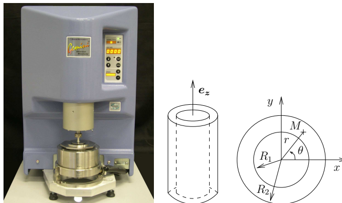
FIG. 4 – Vue et représentation schématique d'une géométrie de type Couette.
