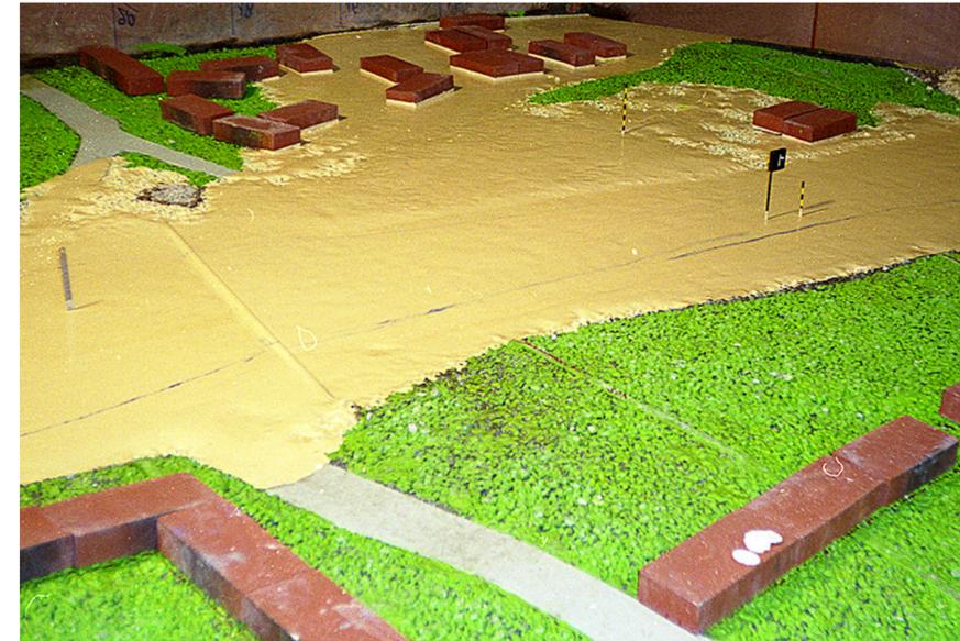
En ingénierie on utilise souvent des modèles réduits présentant la même forme que le modèle en grandeur réelle (similitude géométrique) et on recherche des matériaux et des conditions d'écoulement en laboratoire pour créer des écoulement en similitude (dynamique). La similitude du modèle réduit avec le phénomène à étudier est assurée quand tous les paramètres de similitude sont identiques aux deux échelles.
