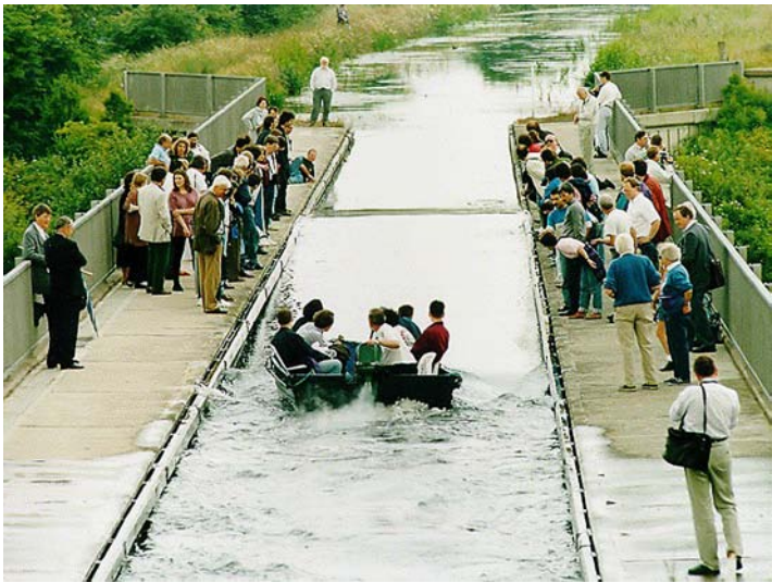
Figure 6.17 : reproduction en 1995 de l’observation d’une onde solitaire faite par Russell dans le canal de l’Union. D’après un document du Département de mathématiques de l’université de Heriot-Watt .
