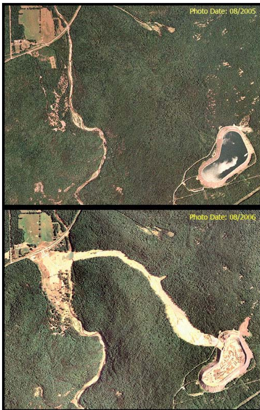
Figure 5.1 : rupture du barrage de Taum Sauk dans le Missouri (États-Unis) en décembre 2005.
