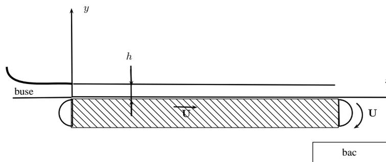
Figure 4 : tapis roulant transport du fluide.
