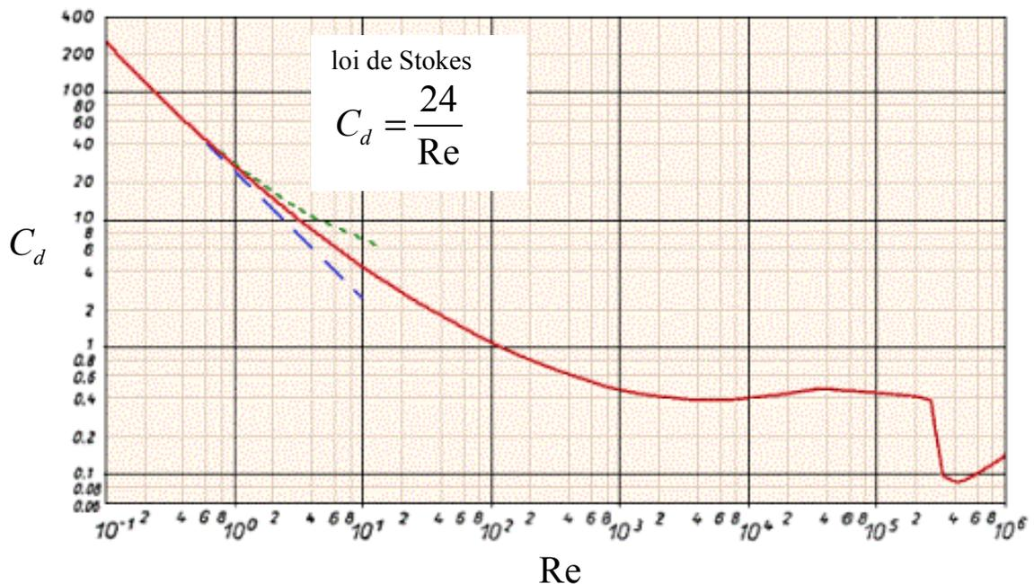
**Figure 3** : variation du coefficient de traînée avec le nombre de Reynolds particulaire avec  $C_d = \frac{F}{\frac{1}{2}\rho a^2 u^2}$  et  $\text{Re} = \frac{2\rho a u}{\mu}$ .
