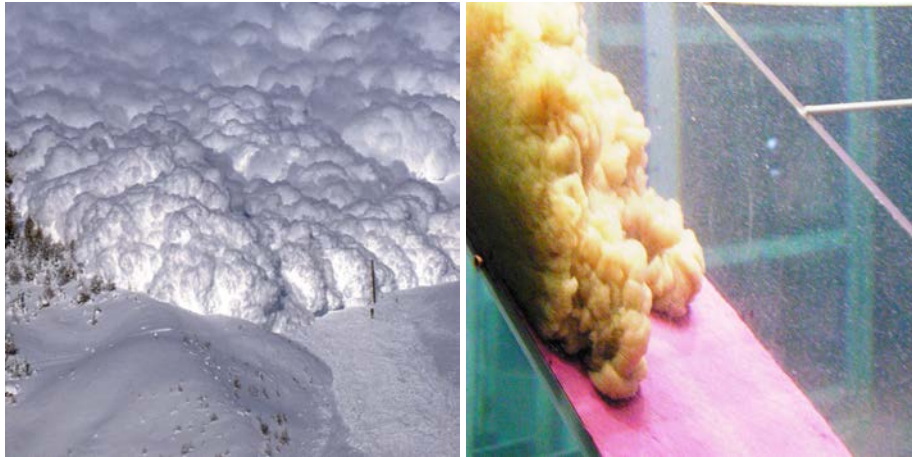
Figure 4 : simulation d'un aérosol à échelle réduite. Pour cet exemple, l'écoulement en laboratoire (cliché de droite) est obtenu en lâchant un mélange d'eau et de particules colorées dans une cuve d'eau.
