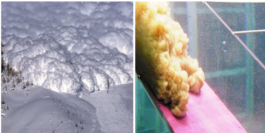
Figure 7 : simulation d'un aérosol à échelle réduite. Pour cet exemple, l'écoulement en laboratoire (cliché de droite) est obtenu en lâchant un mélange d'eau et de particules colorées dans une cuve d'eau.
