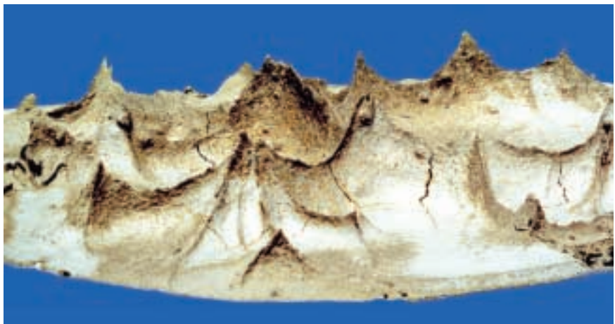
6. FRACTURE D'UNE PÂTE GRANULAIRE par arrachement.
