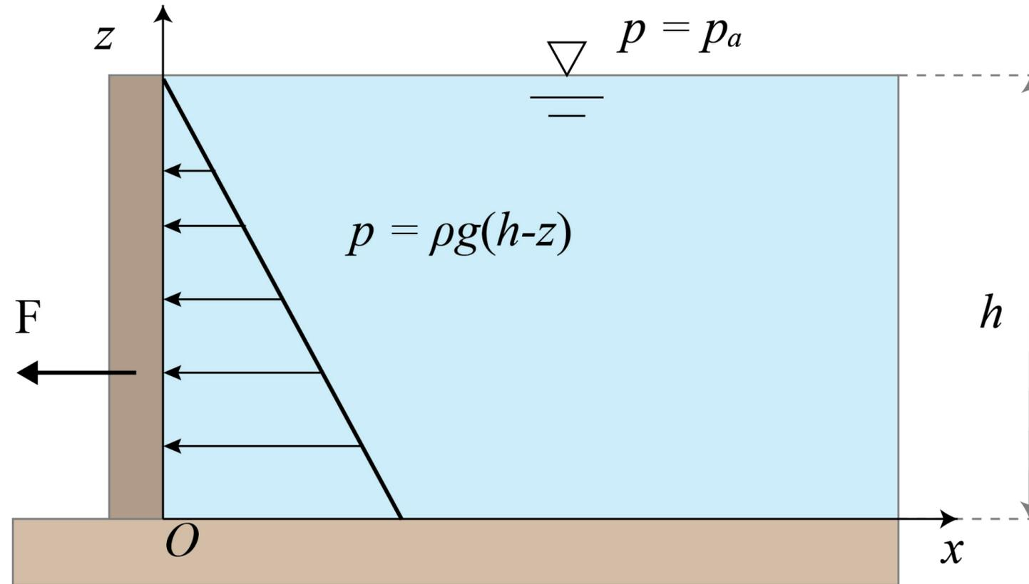
Synthèse : distribution linéaire (hydrostatique) de pression. Comme  $M = Fh/3$ , le point d'application de la force est situé au tiers de la hauteur du barrage (depuis  $O$ ).
