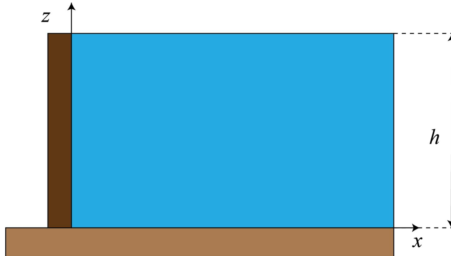
Considérons un barrage rempli d'eau, avec une hauteur  $h$  et une largeur  $\ell$ . On veut calculer la force totale de pression qui s'exerce sur le mur du barrage.
