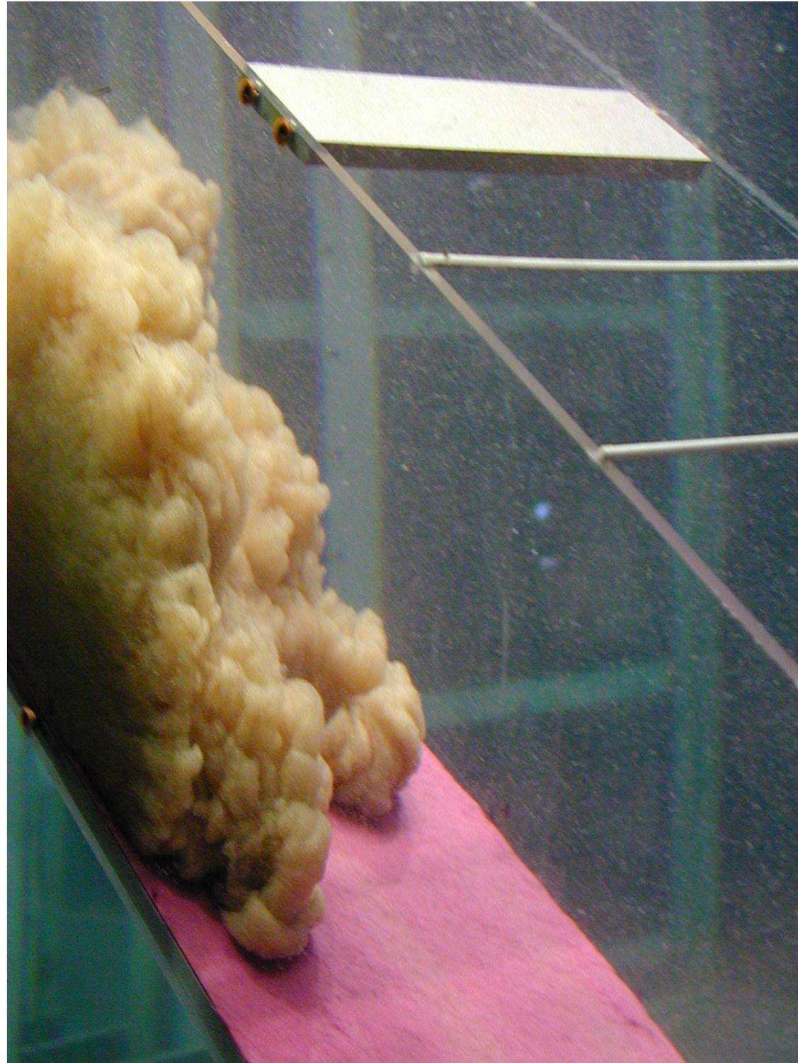
Courant de gravité : écoulement d'un fluide lourd dans un fluide plus léger.
