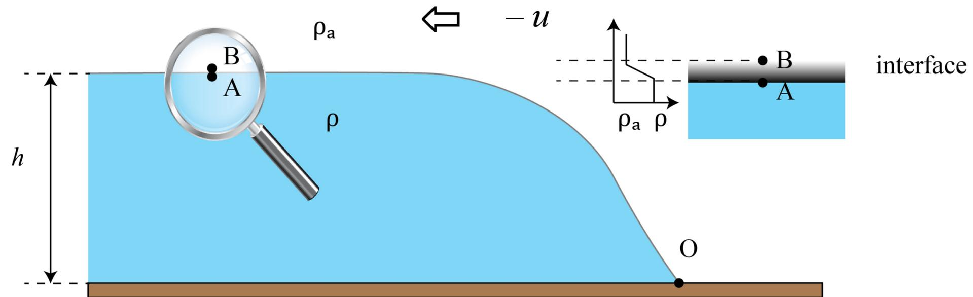
Intrusion d'un courant de densité avec  $\rho > \rho_a$ , se déplaçant à vitesse constante  $u$
