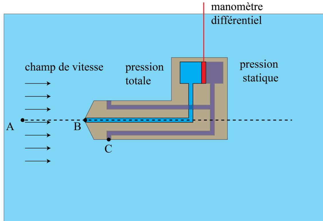
Considérons une ligne de courant A–B. En A, on a  $p = P_A$ ,  $v = v_A = v_\infty$ , et  $z = z_A$ .
