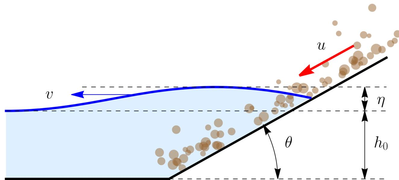
Exemple d'un raisonnement pour calculer la hauteur d'une vague d'impulsion : la vitesse des vagues est  $v = \sqrt{g(h_0 + \eta)}$ . La conservation de la vitesse entre la vitesse de l'avalanche  $u$  et celle de la vague  $c$  donne  $u = v$  (on négligea la dissipation d'énergie), et donc on déduit
