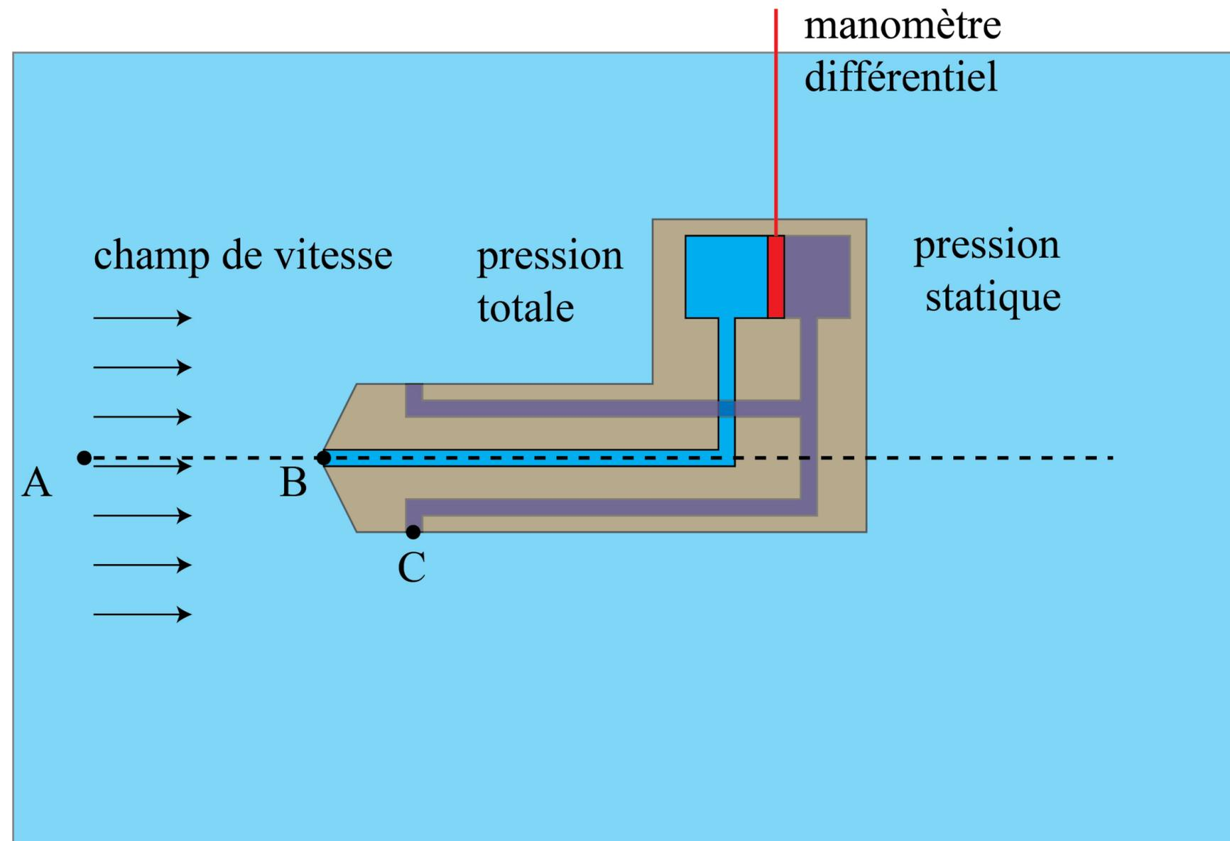
Immersion d'un tube Pitot parallèlement aux lignes de courant.
