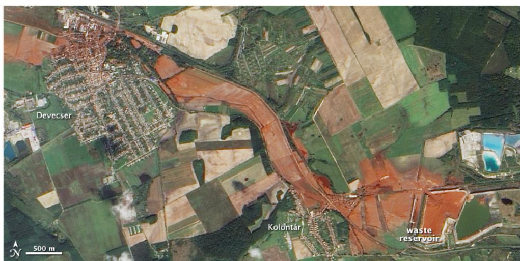
**Figure 3.14** – Zones inondées par la rupture du bassin de décantation de l’usine d’Ajka en Hongrie. Photographie satellitaire prise le 9 octobre 2010. Source : [NASA](#).
